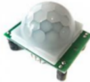
Şekil 2.6. Hareket sönsörü (PIR HC-RS501)
