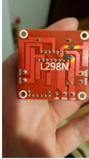
Şekil 4.1. Yanmış L298N voltaj regülatörlü çift motor sürücü kartı
